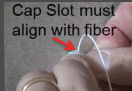
La fente et la fibre doivent être alignées
